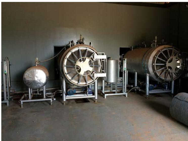
O sistema de tratamento de choroço possui licença de instalação nº IN029753 e baseia-se no tratamento físico-químico e POA (processo oxidativo avançado).
