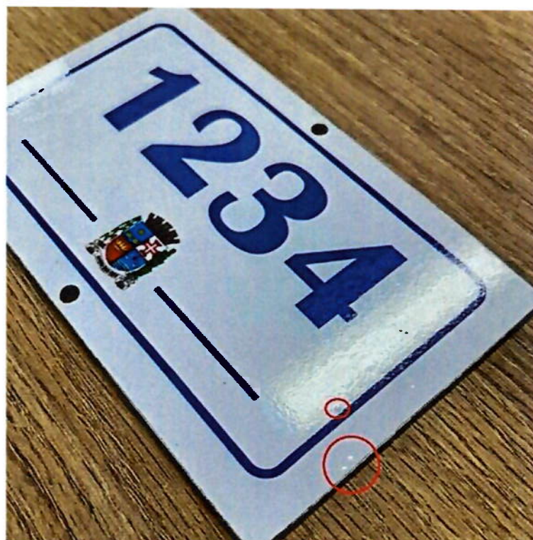
Foto 2: Bolhas no adesivo da amostra.
