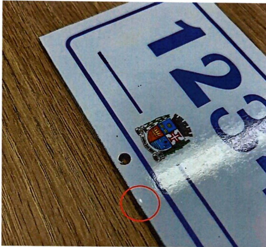
Foto 3: Bolhas no adesivo da amostra.
