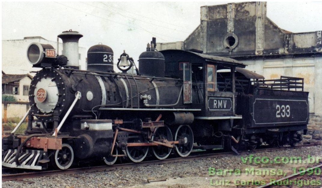
Figura 63 - Locomotiva a vapor 4-6-0 nº 233 da antiga RMV
